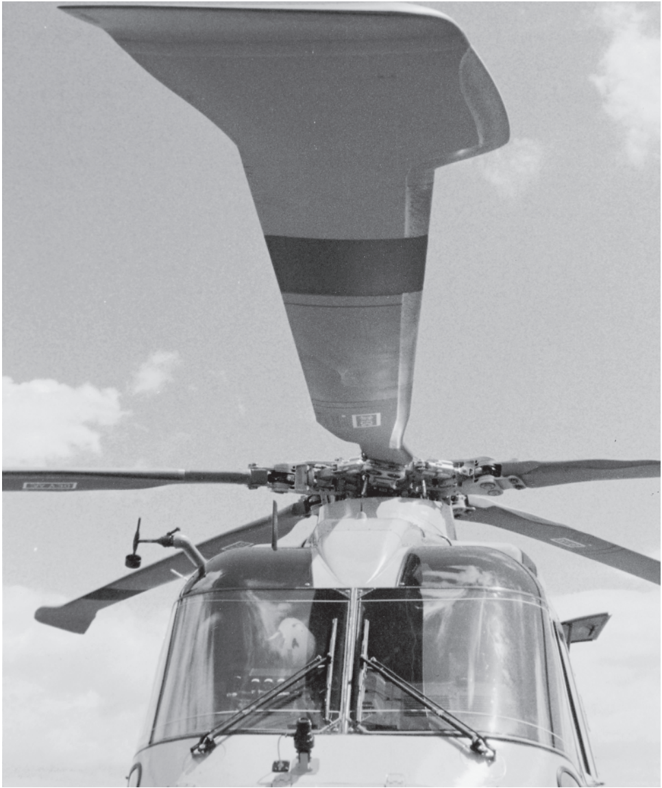
Fig. 6.37 The BERP blade
